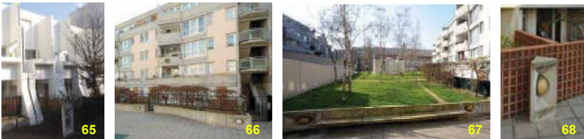
Isolées ou intégrées au mobilier au niveau des bancs ou dans les jardinières, posées verticalement ou horizontalement, les bornes lumineuses se retrouvent sur chacun des îlots. Ce module rectangulaire intégrant l'éclairage pourrait être repris systématiquement comme seul modèle que ce soit au sol ou en élévation afin de favoriser la cohérence de l'ensemble. La forme pourrait être réutilisée avec des matériaux actuels.
